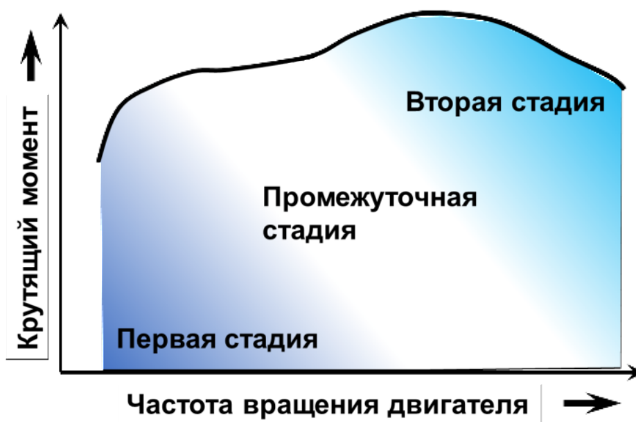
Рисунок 4.5 – Характеристика двигателя при поэтапном параллельном турбонаддуве
