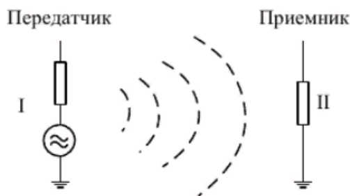
Рисунок 1.21 – Связь через электромагнитное излучение
