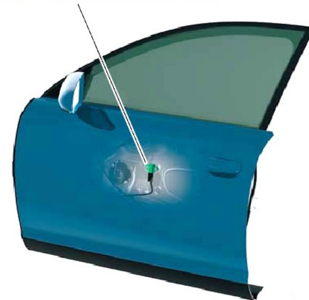
Датчик давления (датчик удара боковой подушки безопасности водителя)
