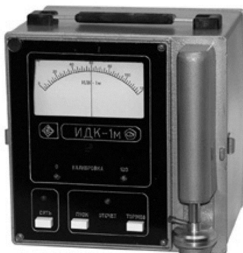
Рисунок 15.1 – Прибор для определения физических свойств сырой клейковины – индикатор деформации клейковины (ИДК-1)
