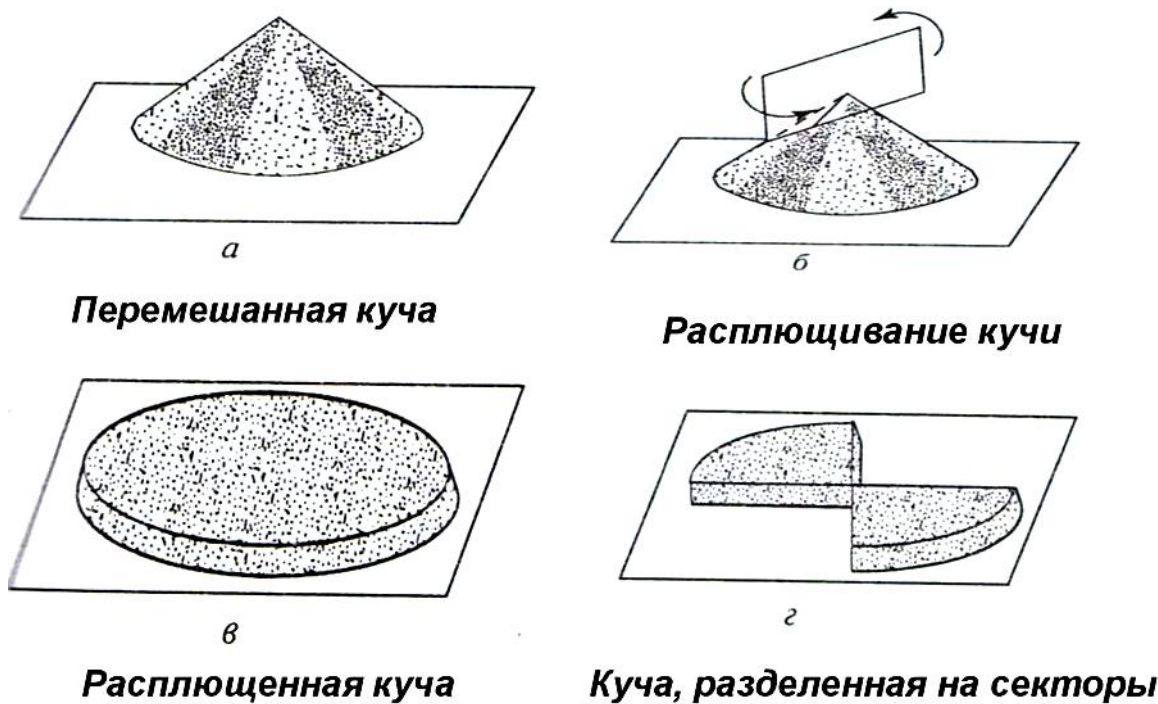
Рисунок 1.5 – Деление навески сырья в ручную способом квартования
