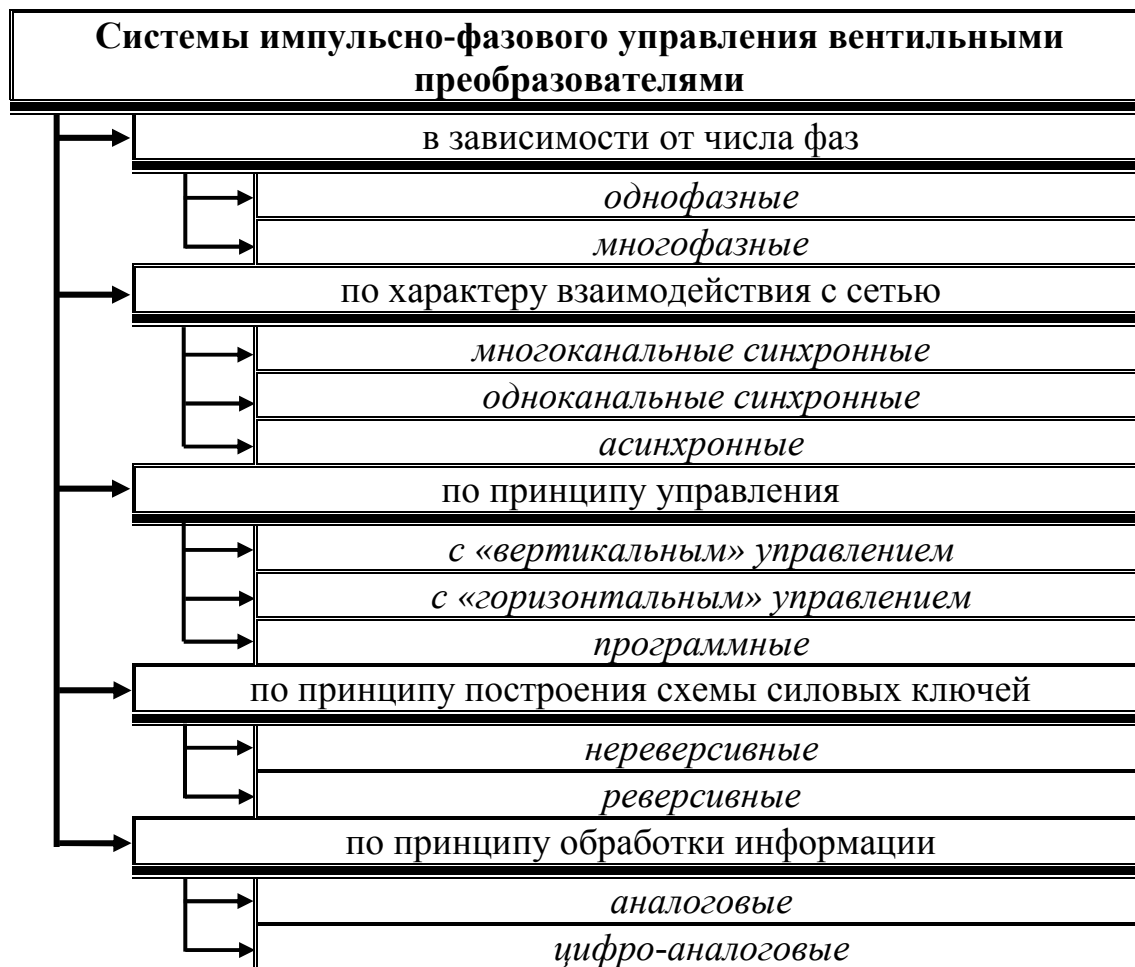
Рис. 9.1. Классификация систем импульсно-фазового управления вентильными преобразователями
