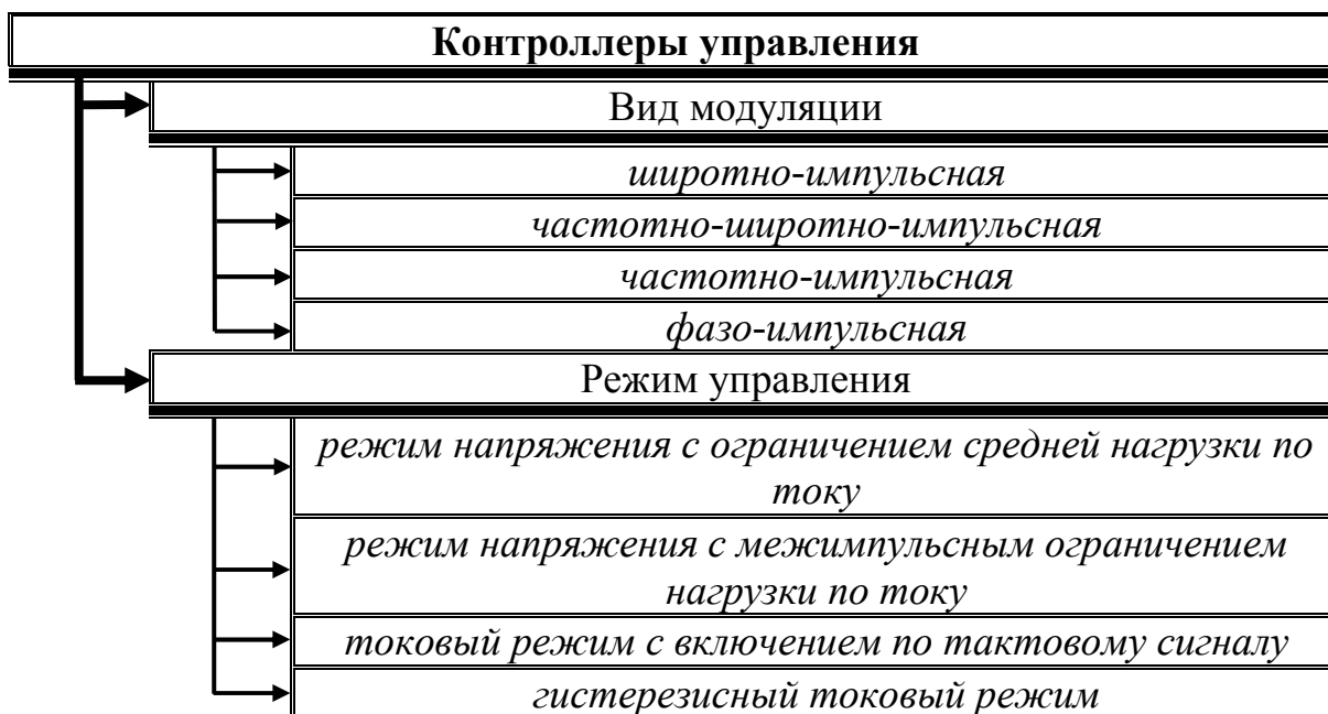
Рис. 19.1. Классификация контроллеров управления
